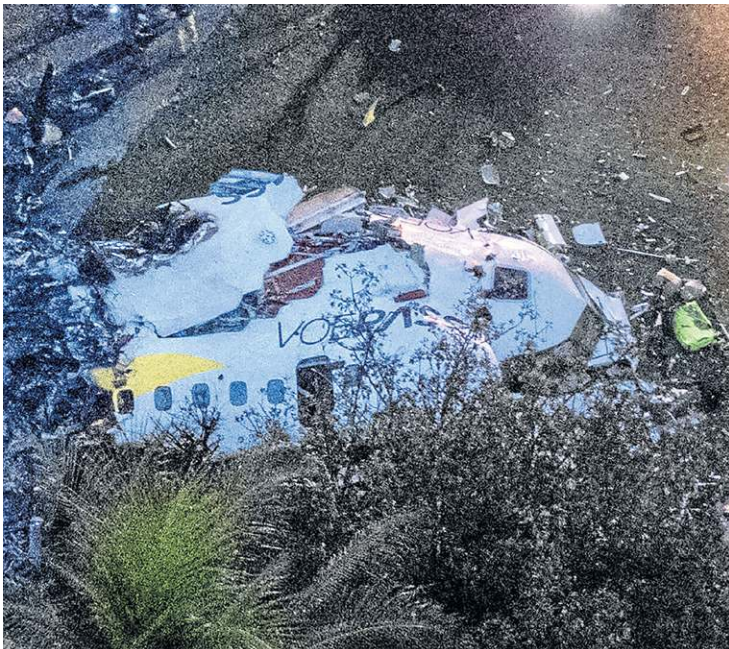
Aeronave entrou em parafuso e caiu por acúmulo de gelo nas asas
