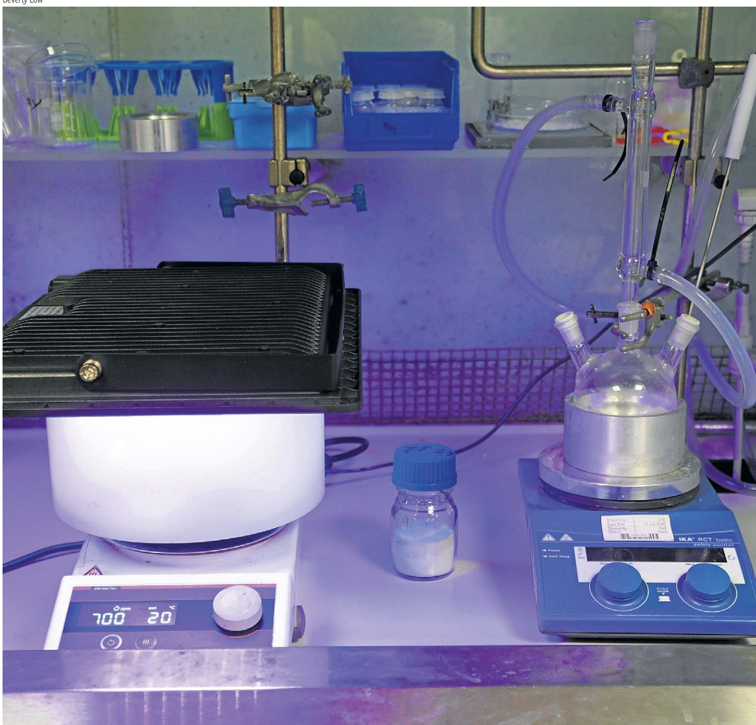
Reator criado pelos pesquisadores transforma resíduos plásticos e ácido de baterias utilizadas em hidrogênio verde e produtos úteis
