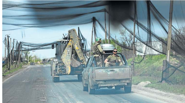
Estrada coberta com redes contra ataques de drones, na Ucrânia
