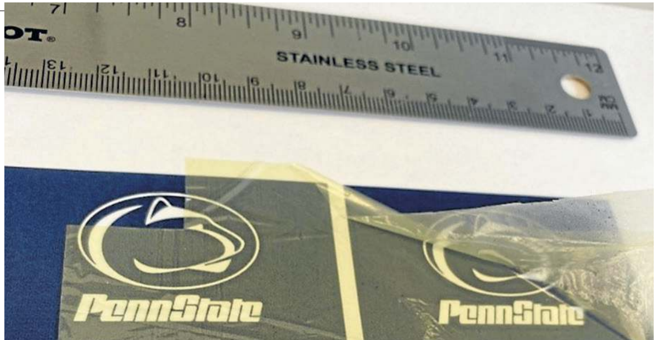
Pesquisadores desenvolveram um capacitor de polímero combinando dois plásticos baratos e disponíveis comercialmente
