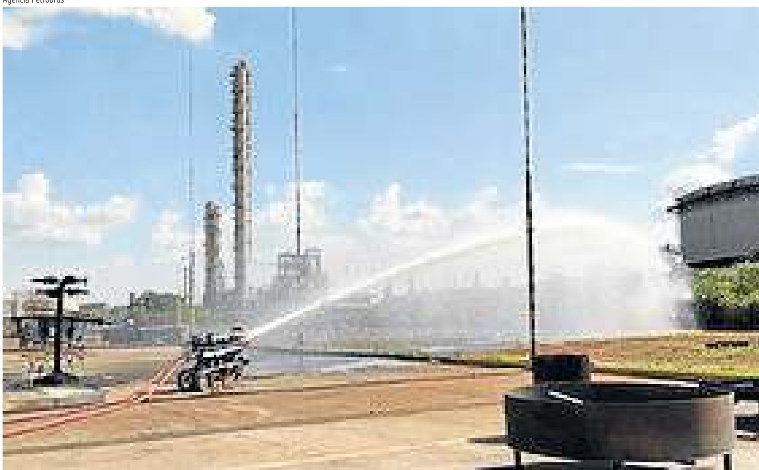
Robô inédito no país que ajuda no combate a incêndios é resultado do primeiro contrato de cotitularidade da Petrobras
