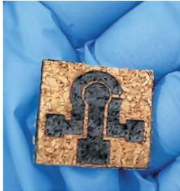
No ponto tratado com laser, forma-se um circuito elétrico que vira sensor
