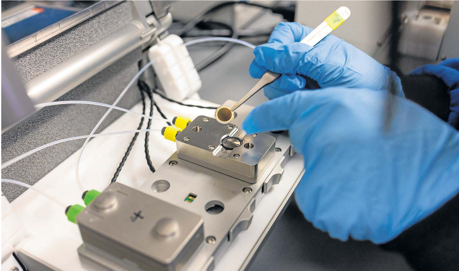
Cientista manipula o pequeno chip circular, que será utilizado no dispositivo final e funcionará como uma espécie de “nariz eletrônico”
