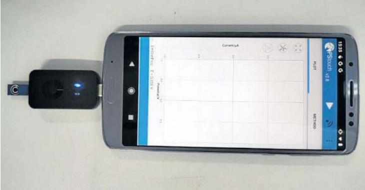
Dispositivo pode ser conectado à porta USB-C de um celular
