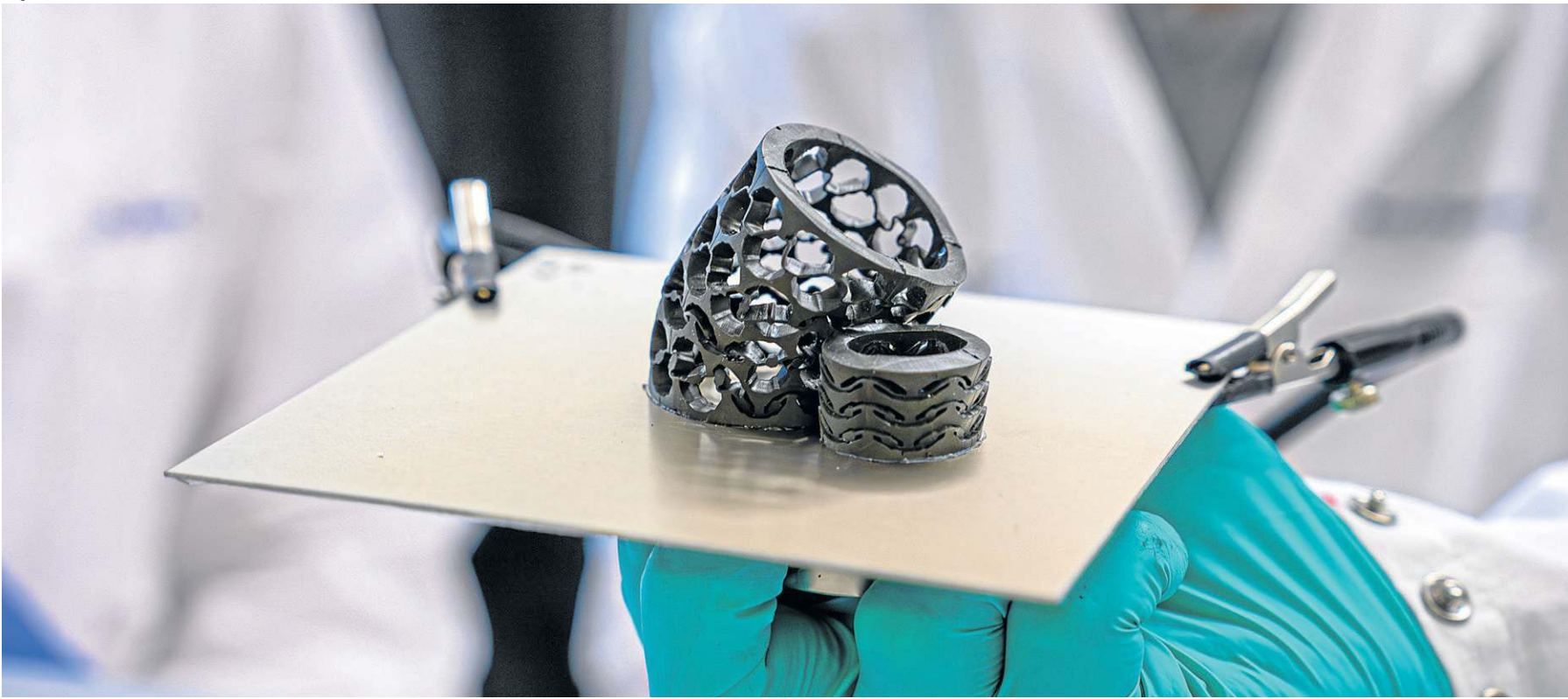
O novo metamaterial projetado por Kong e sua equipe na Rice pode ser controlado remotamente para transformar rapidamente seu tamanho e forma
