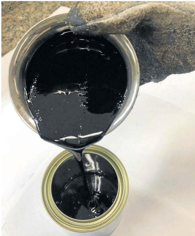
**O plástico é misturado com o asfalto pelo processo chamado “via úmida”, que utiliza água para misturar os dois materiais**
