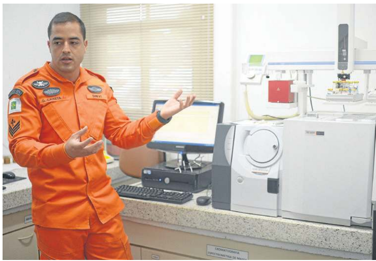
Sargento G. Caixeta mostra o cromatógrafo gasoso acoplado ao espectrômetro de massa, que custou R$ 5 milhões
