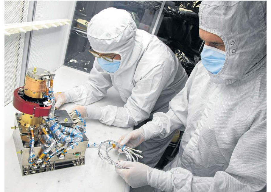
A equipe repara o sensor para integração em um satélite que fará o rastreamento
