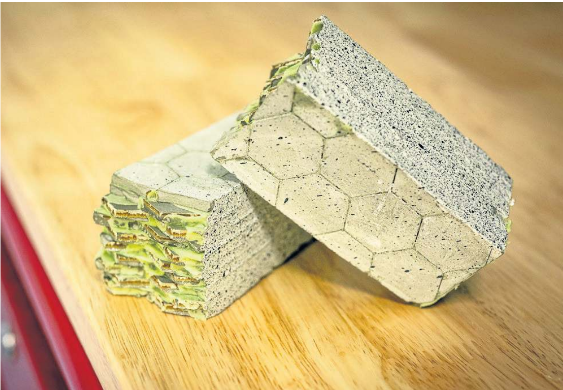
Amostras de vigas com camadas alternadas de ladrilhos de cimento hexagonais e polímero fino
