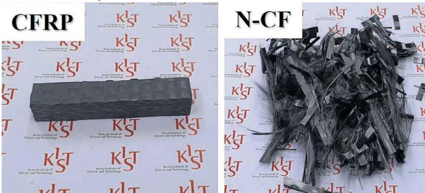
Antes e o depois da transformação do material de CFRP, in natura, para N-CF, modificado
