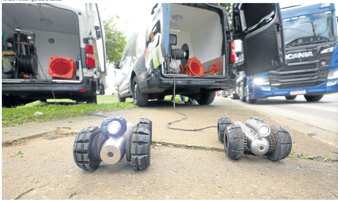
Sistema mecanizado acelera a limpeza de redes inteiras de drenagem com a vídeoinspeção robotizada
