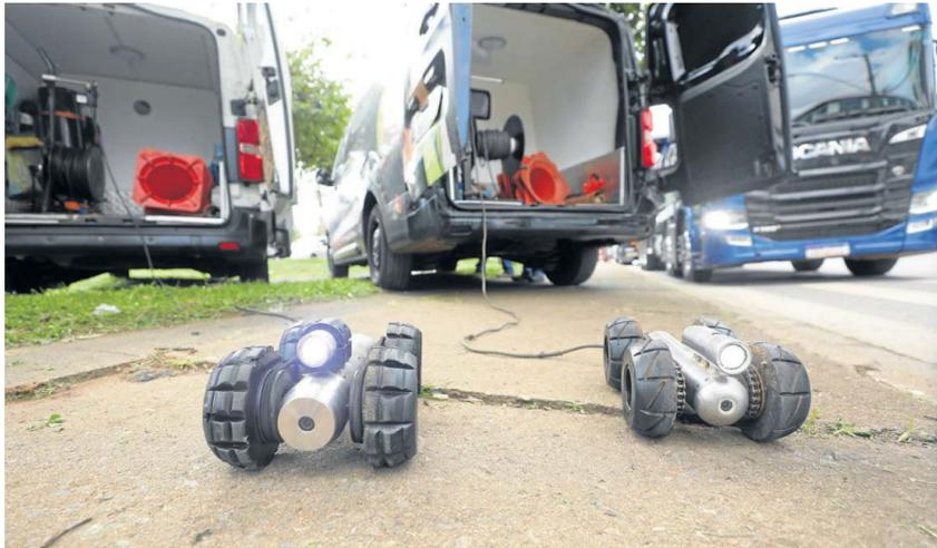
Sistema mecanizado acelera a limpeza de redes inteiras de drenagem com a vídeoinspeção robotizada
