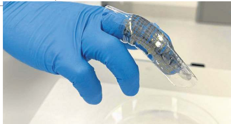
Impressa em polímeros flexíveis, a tecnologia converte energia mecânica em elétrica
