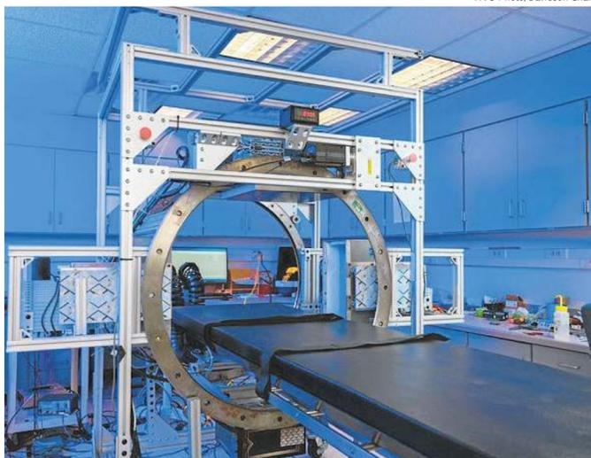
**Protótipo combina o funcionamento do Pet-Scan e da tomografia por raios X**
