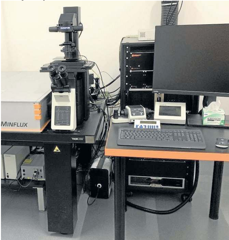
Nova versão do Minflux, desenvolvido pelo Max Planck Institute for Medical, tem precisão de até 1,7 nanômetro por milissegundo
