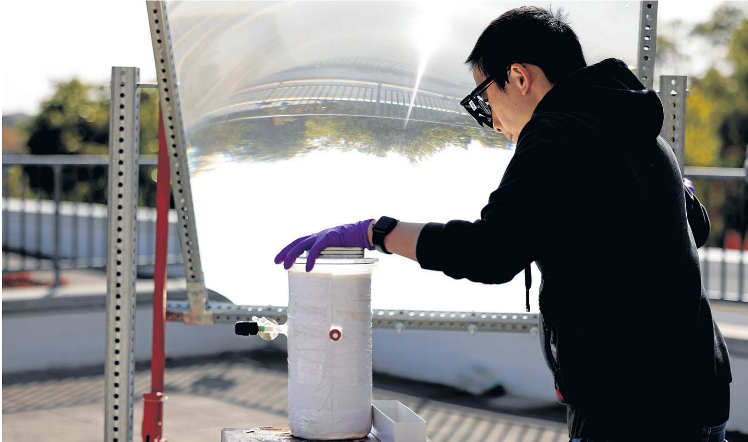
Os pesquisadores utilizaram uma lente do tamanho de uma janela para concentrar a luz solar no catalisador de separação de água
