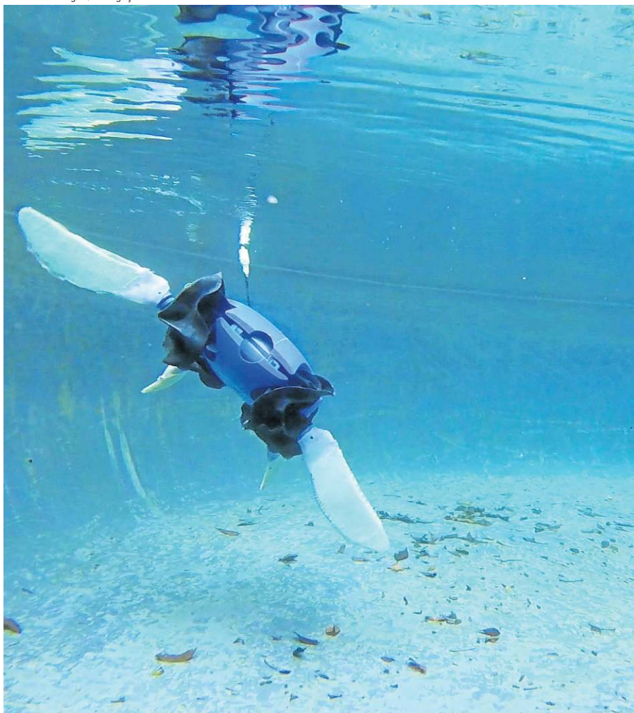
Androide híbrido: inspirada na anatomia de uma tartaruga, máquina criada por equipe da Universidade de Yale muda o formato da pata para se deslocar na água e na terra
