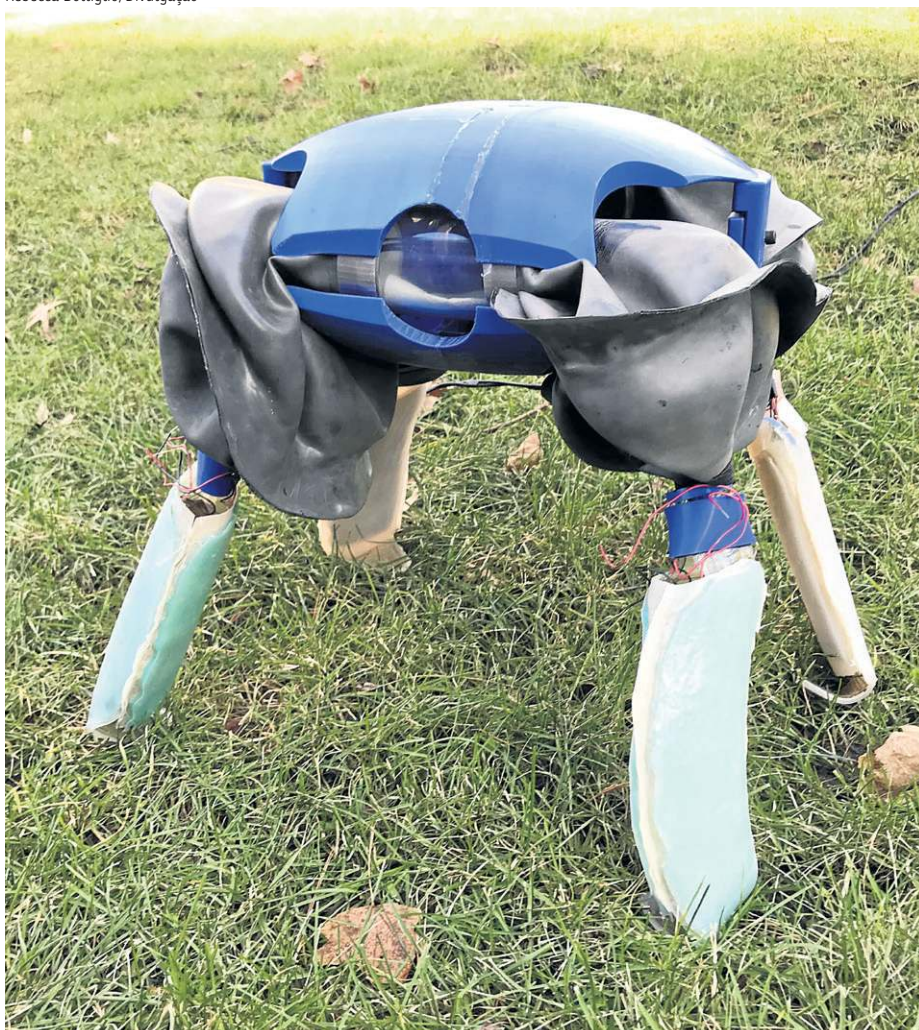
Androide híbrido: inspirada na anatomia de uma tartaruga, máquina criada por equipe da Universidade de Yale muda o formato da pata para se deslocar na água e na terra
