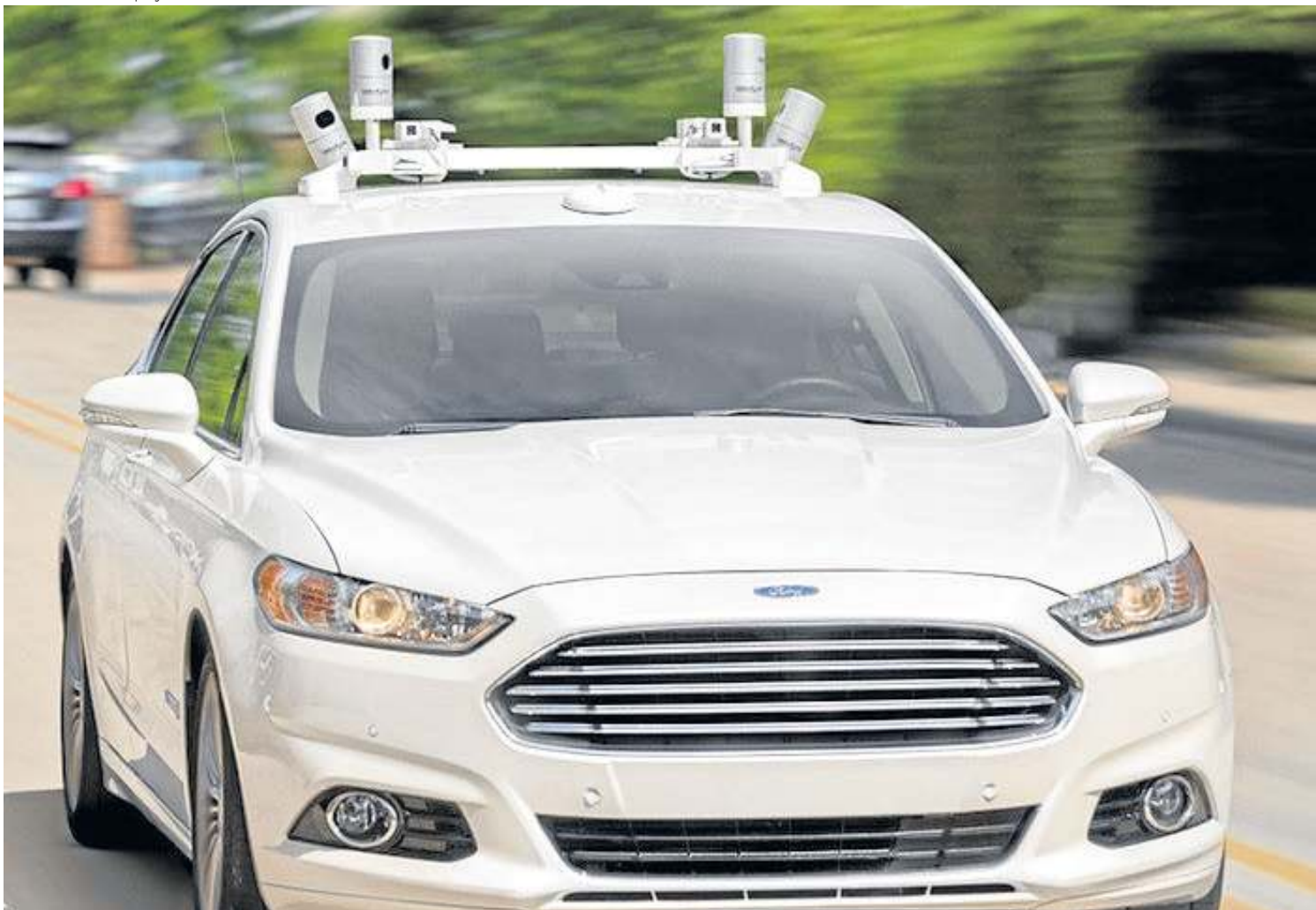
Sistema permite que câmeras e sensores “interpretem” as condições de dirigibilidade ao redor e aumentem a autonomia dos veículos
