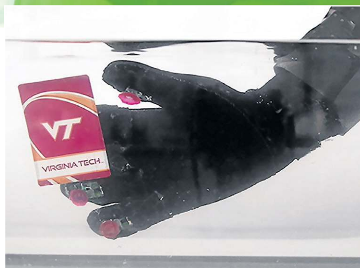
A Octa-glove tem ventosas com hastes de borracha e sensores ópticos de proximidade: testes com resultados promissores
