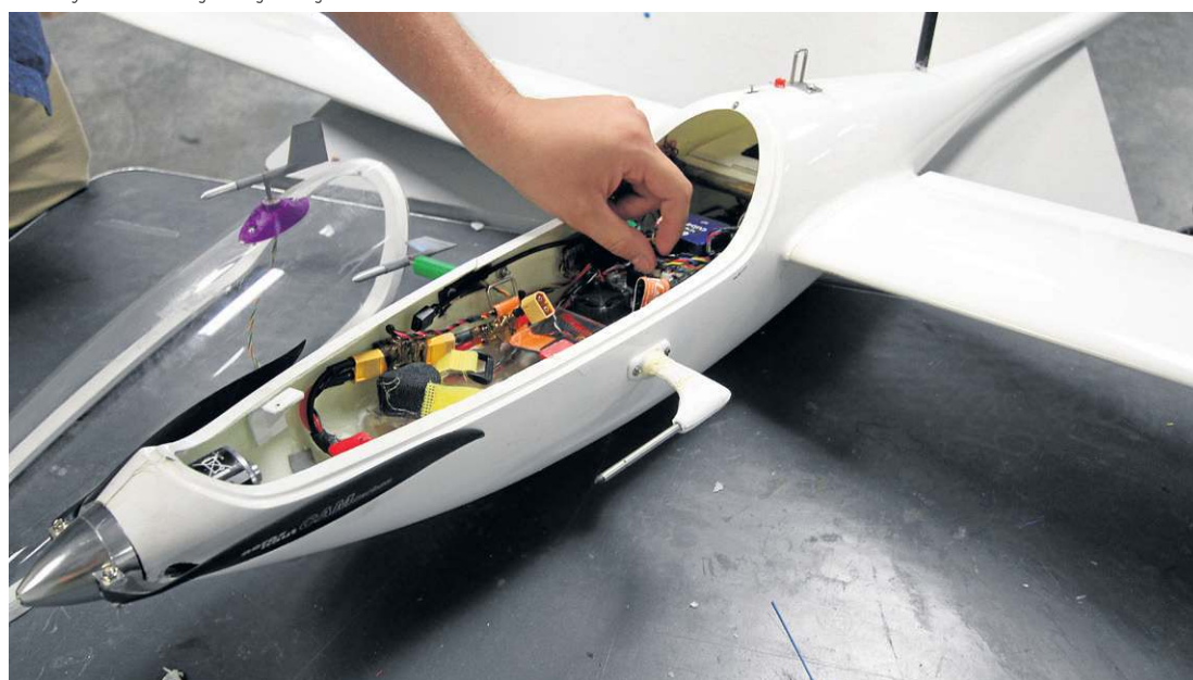
A aeronave pesa menos de 5kg e carrega câmeras e sensores de voo, temperatura e gás
