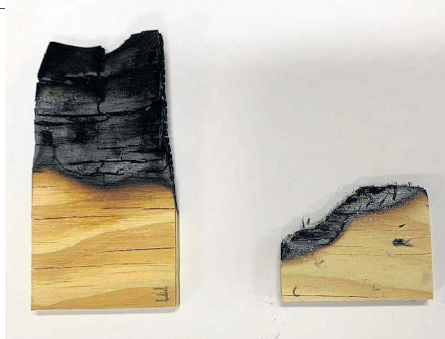
Madeira tratada com a resina (esquerda), ao lado de uma peça não revestida: menos chamas e fumaça
