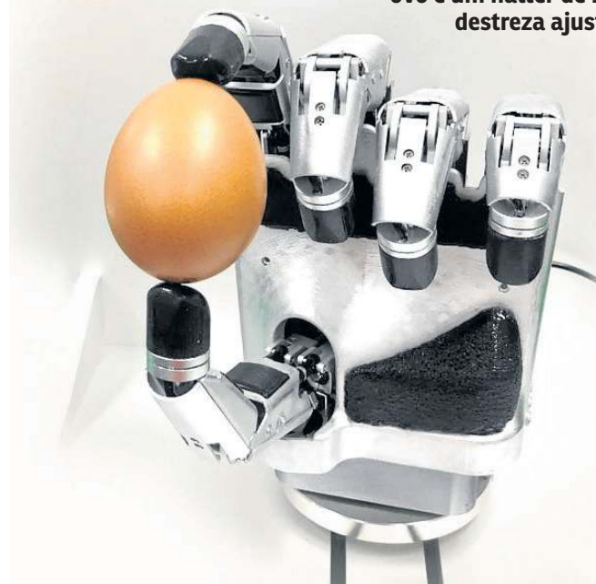
Dispositivo criado na Coreia do Sul segura um ovo e um halter de 18kg: destreza ajustável
