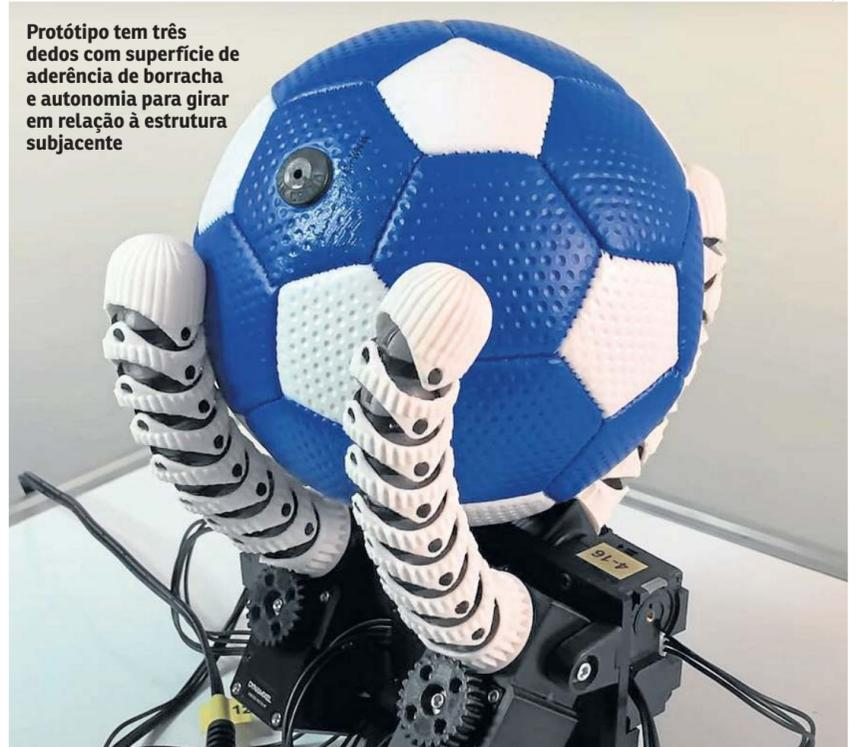
Protótipo tem três dedos com superfície de aderência de borracha e autonomia para girar em relação à estrutura subjacente
