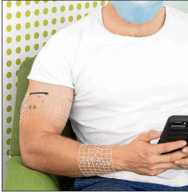
O vestível bio-simbótico usa transmissão de energia sem fio para funcionar 24 horas por dia
