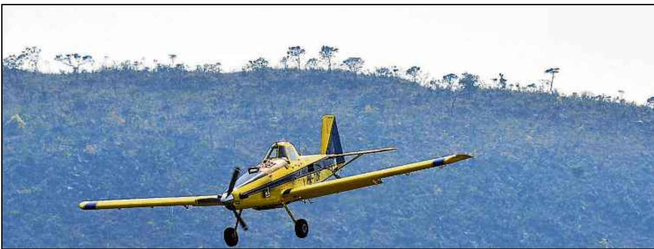
Aviões air tractor podem levar até 3 mil litros de água. Três aeronaves do tipo atuam no combate às chamas na região da Chapada
