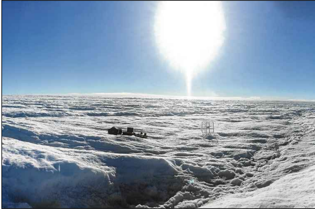
Antena captura sinais solares para medir a profundidade das camadas em que está fixada: método dispensa a vigilância com aviões
