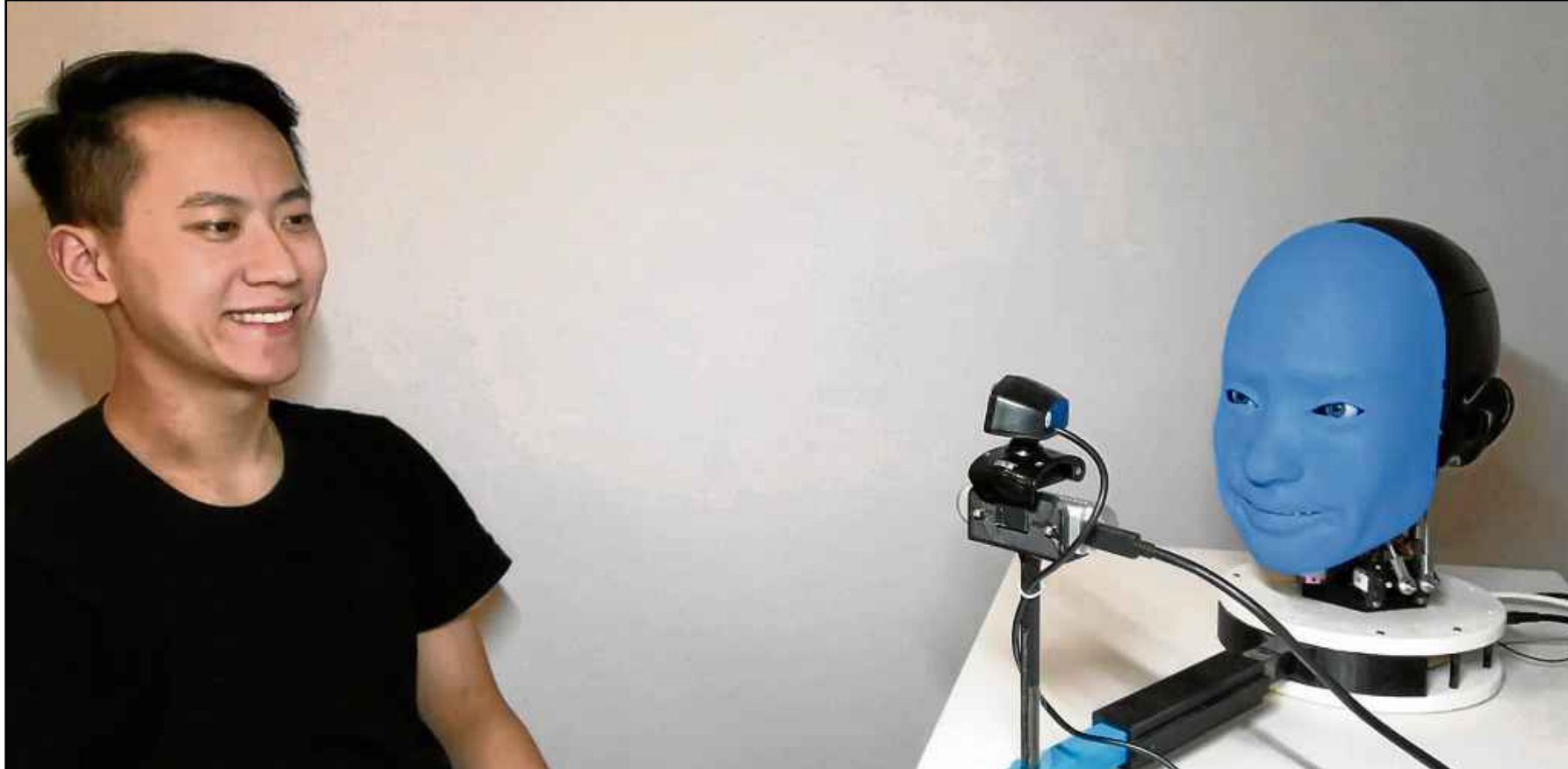
EVA imita expressões faciais humanas, em tempo real, a partir de uma câmera: cabos e motores funcionam como músculos artificiais
