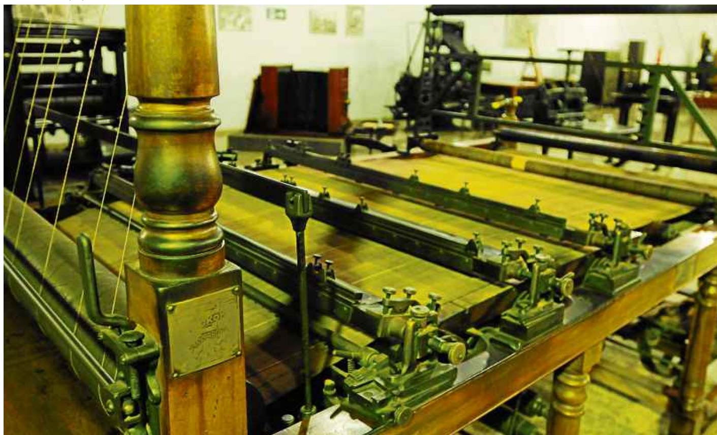
Equipamento antigo era usado para fazer linhas em páginas produzidas com pauta à época
