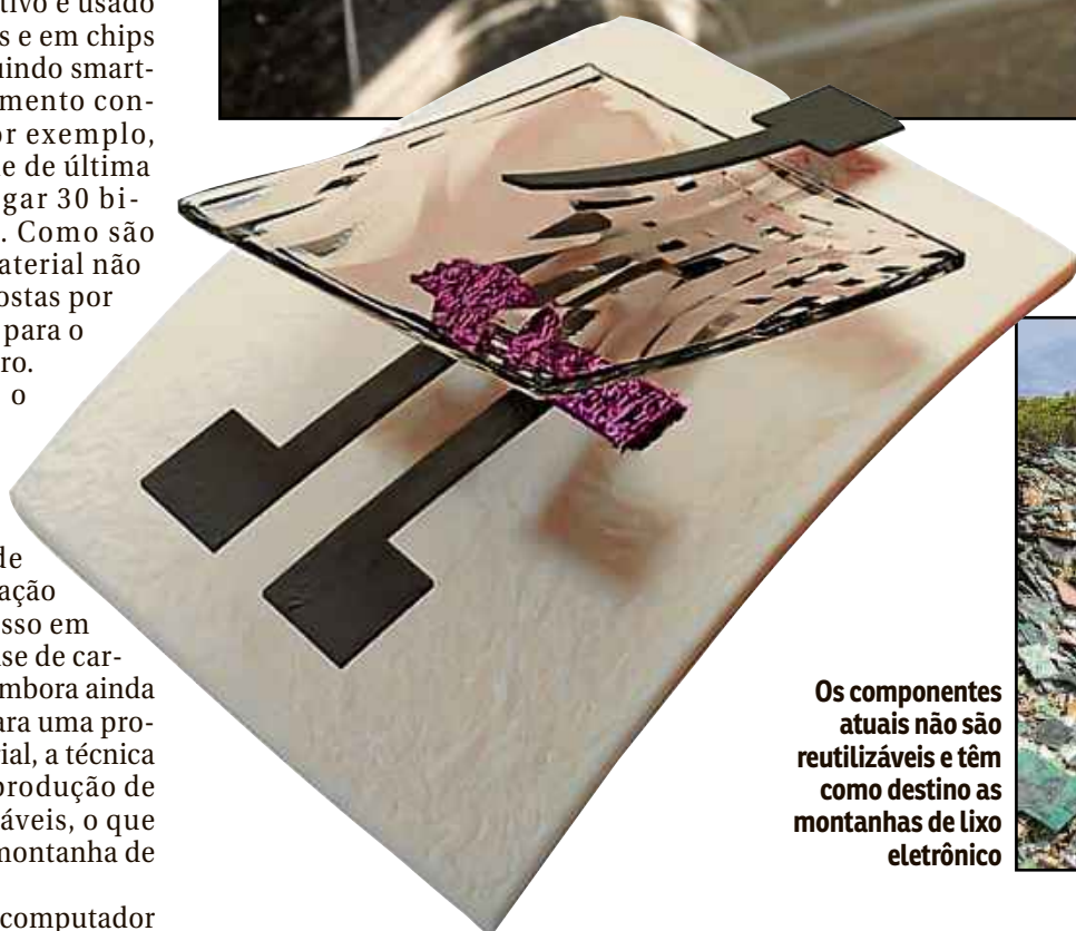
O novo transistor pode ser usado em chips de computadores e celulares: testes mostram pleno funcionamento seis meses após a impressão
