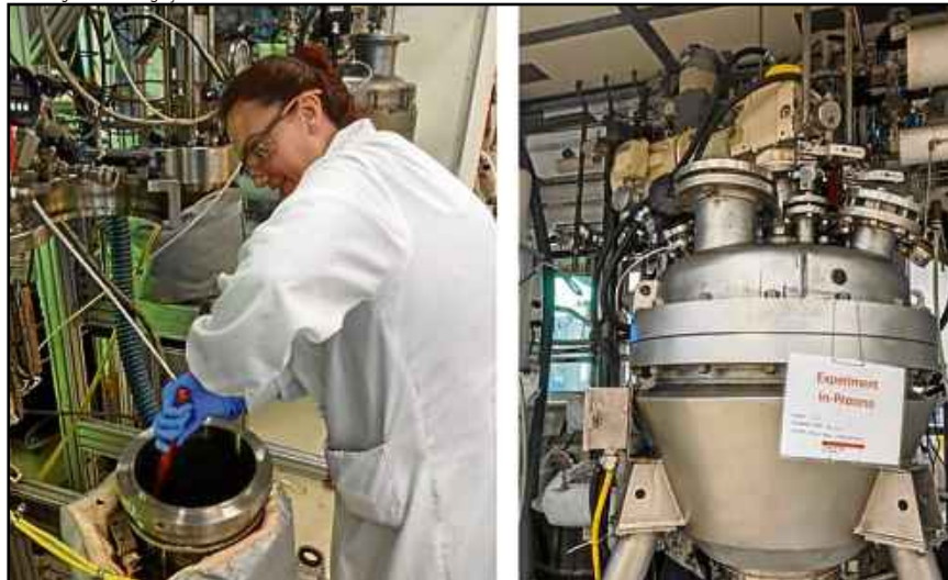
Preparo da síntese do combustível (esquerda), produzido em um único reator (direita)
